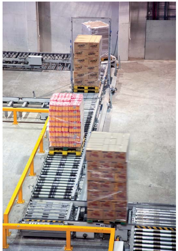
שער הבדיקה, שבוחן כל משטח לפני הכנסתו למחסן האוטומטי
