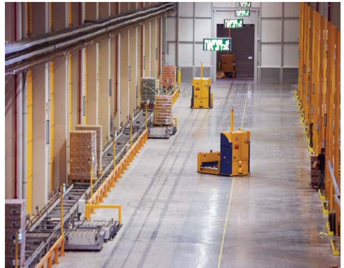
כלי-שינוע מונחים אוטומטית, שמחדשים את המלאי באזור הליקוט
